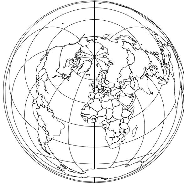
Cherchons la valeur de  $\varrho$  pour que la projection azimuthale qu'elle détermine par (23) soit équivalente. L'équation (20) s'écrit
