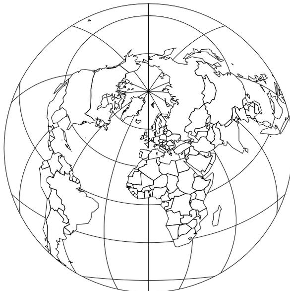
La projection azimuthale *équidistante* est définie sur (23) par :
